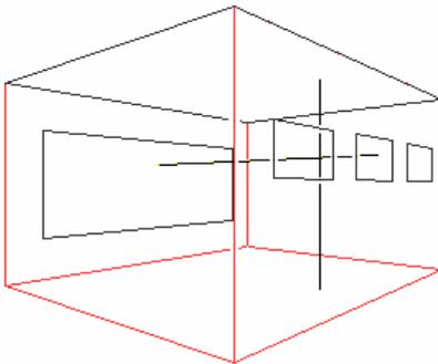
**Bild 04:** Modellraum mit drei elektrischen Heizflächen gegenüber dem Fenster
